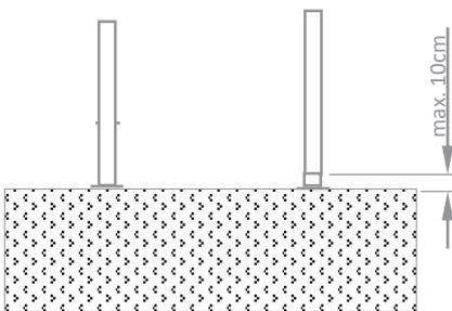
Schieben Sie die Multi-Pfosten bis zur Schweißnaht auf die Pfostenträger.
