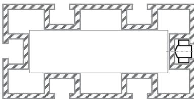
Führen Sie die Nutensteine mit den Madenschrauben in die T-Nut ein und ziehen Sie die Schrauben fest an.
