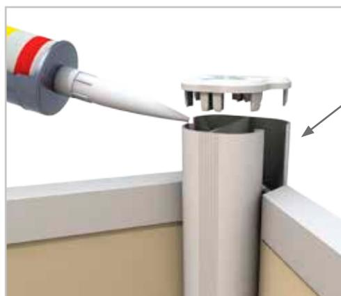
**Wichtig:** Das Zaunfeld dehnt sich bei Sonneneinstrahlung aus. Der Spalt oben dient als Dehnungsfuge und darf nicht verschlossen werden.
