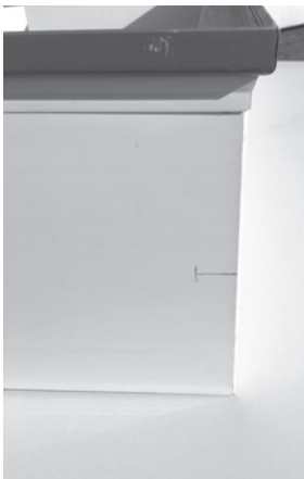
Position der Verstärkungseisen ermitteln und Profilstärke (35 mm) anzeichnen
