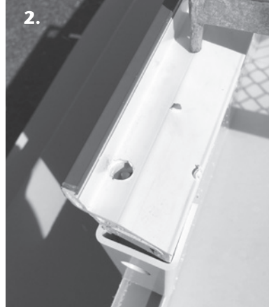
2. Rostzapfenloch mit 10 mm Bohrer bohren
