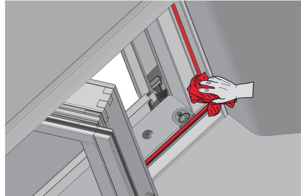
4. Sprühen Sie ein Dichtungspflegemittel auf ein Tuch und tragen Sie es auf die Flügeldichtung am unteren Flügelrahmen auf.
