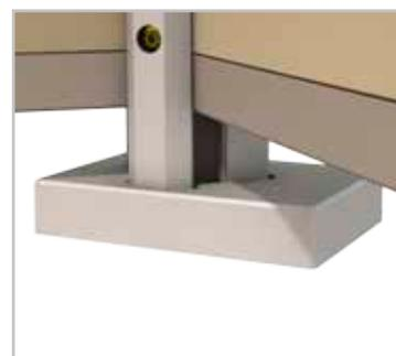
Élargissez l'ouverture du sabot d'habillage de l'ancrage à visser en pliant avec précaution la ligne pré-perforée. Limer éventuellement l'arête de coupe.
